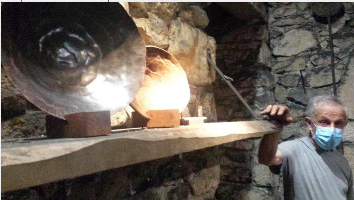
• Les "coupes", récipients forgés au marteau hydraulique. LR /
